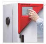
TEMPERATURE RANGE LIMITED TO 120°C ON THE CONTROLLER
